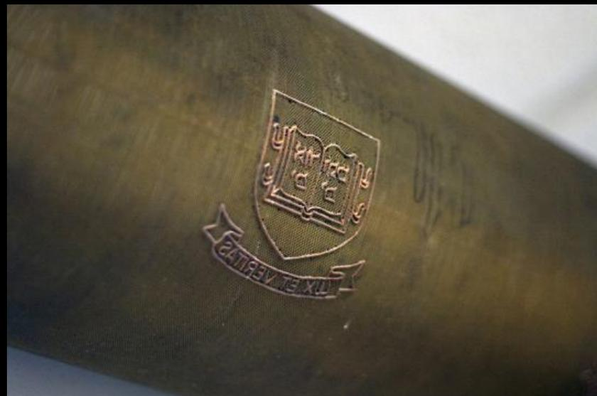
Dandy roll fabricada em 1826 por John Marshall. Revolucionou o processo de impressão das marcas de água no papel.
